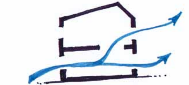
TRAVERSANTE AVEC TIRAGE THERMIQUE
